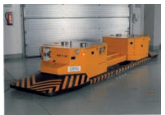
1994 Siemens-Unterfahrerschlepper für Brennelemente
