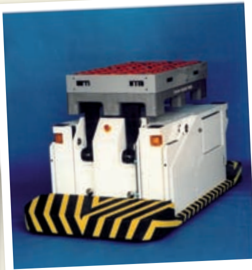
1989 "Dachs" - FTS mit Wahl- möglichkeit zwischen Gabel- oder Hubtischbetrieb
