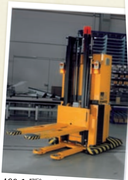
1993 FTS mit Lasernavigation (bis heute im Einsatz)
