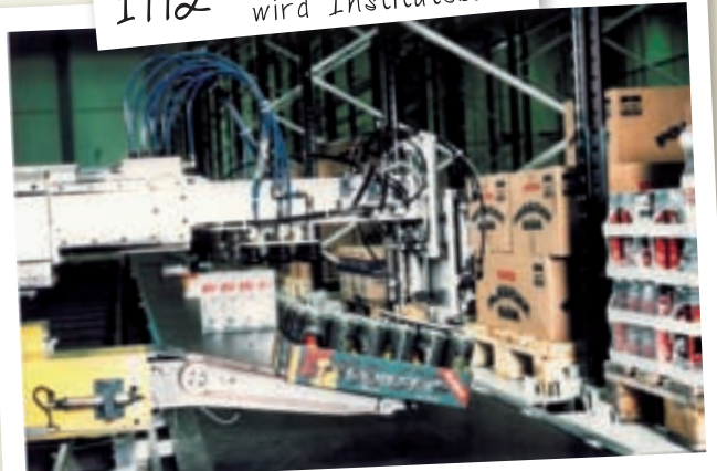
1992 "Aleks" - Erstes automatisches Lebensmittelkommissioniersystem
